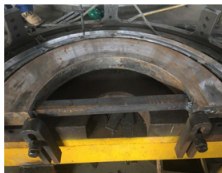
Установка позиции решетки с телом, ободом диафрагмы. Сварка жёсткого обода
