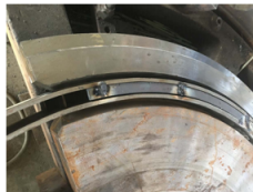
Установка позиции решетки с телом, ободом диафрагмы. Сварка жёсткого обода
