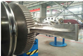
Обработка кольца и облопачивание
