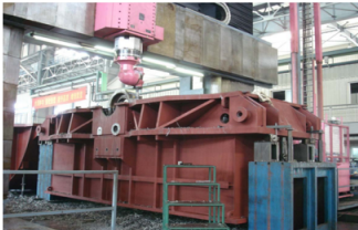
обработка внутренних корпусов ВД и облопачивание
