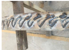
Установка позиции решетки с телом, ободом диафрагмы. Сварка жёсткого обода
