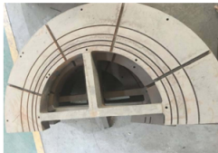
Установка позиции решетки с телом, ободом диафрагмы. Сварка жёсткого обода
