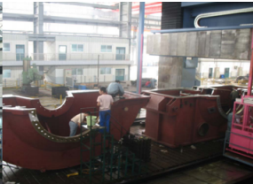
обработка внутренних корпусов ВД и облопачивание
