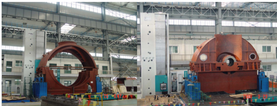
TOSHIBA 300MW Обработка наружного корпуса НД
