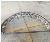
Установка позиции решетки с телом, ободом диафрагмы. Сварка жёсткого обода
