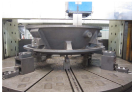
Обработка кольца и облопачивание
