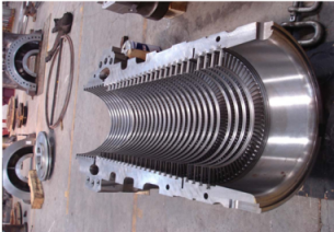
обработка внутренних корпусов ВД и облопачивание
